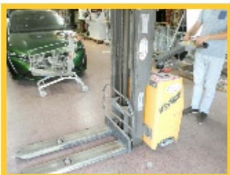
Transpallet FAAC provvisto di carica batteria.
