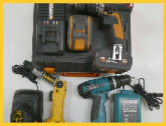
Avvitatore multiuso marca Work mod. wx373.3 completo di caricabatterie, batteria di ricambio e contenitore; avvitatore marca Makita mod. 275242y completo di caricabatterie e batteria di ricambio, avvitatore marca De Walt mod. dw 920 matr. 038764 completo di carica batterie e batteria supplementare.
