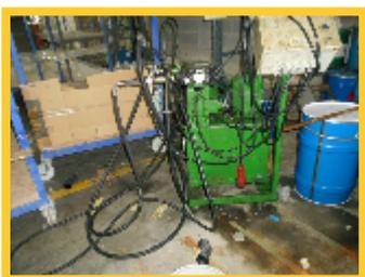
Lotto N. 123) Centrale oleodinamica/circuito oleodinamico per la produzione di energia meccanica DUPLOMATIC-DS5-52-10N-K1 con elettrovalvole direzionali che comandano il movimento delle parti di un "sistema".
