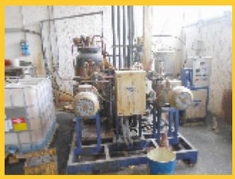
Lotto N. 17) Schiumatrice Cannon Eco plus 100 kg a 4 Teste bassa pressione con impianto di piping.
