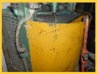
Lotto N. 70) Compattatore elettromeccanico verticale per fusti metallici di grande dimensione.
