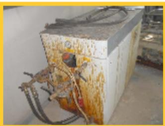
Lotto N. 54) Batteria frigo non funzionante - utilizzato per abbattere temperatura interna stampi.
