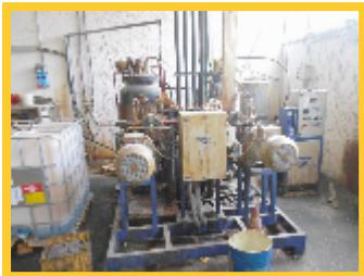
Lotto N. 17) Schiumatrice Cannon Eco plus 100 kg a 4 Teste bassa pressione con impianto di piping.
