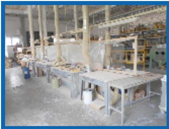
Lotto N. 62) N. 10 banchi aspiranti di costruzione artigianale, per lavorazioni di finitura, con aspirazione dal basso completi di piano di lavoro e canalizzazioni di allontanamento polveri.
