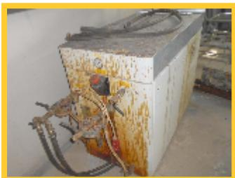
Lotto N. 54) Batteria frigo non funzionante - utilizzato per abbattere temperatura interna stampi.
