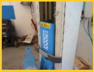
Ponte sollevatore a due colonne, 35 Q.li di portata, marca O.M.C.N, attualmente in parte smontato da ripristinare, anno di produzione 2009.
