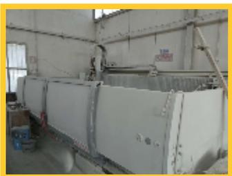
Macchina a controllo numerico Intermac Master 30, sprovvista di testine.
