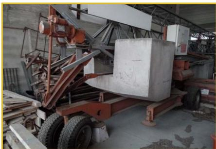
Lotto B)GRU edile a torre automontante marca Benazzato mod. 197 ? 14.16, braccio mt.16, altezza mt.14, portata max. Kg.1.000, portata max. in punta Kg. 400, con radiocomando, secchione e forca, anno di costruzione 2000.
