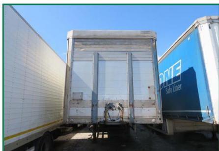
Lotto 6) Semirimorchio Sud Trainer immatricolato il 12/04/1995, portata 30230, assi n.ro 4, in cattivo stato di manutenzione, numerose tracce di ruggine, fanalini posteriori completamente smontati, danneggiato impianto attacco aria e olio. Il semirimorchio è provvisto del libretto.
