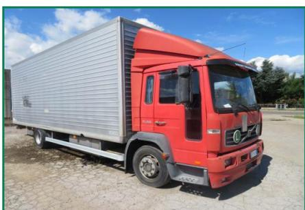
Lotto 3) Autocarro Volvo immatricolato il 17/12/2002, cilindrata 5480 alimentazione a gasolio uso furgone portata 4750 sprovvisto della rampa di carico posteriore. Il mezzo risulta largamente usurato e da tempo fermo, la mancanza delle batterie non ha permesso di testarne il funzionamento, blocchetto di apertura rotto ed interni in parte danneggi...
