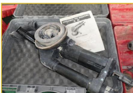
Fresa da muro elettrica con aspiratore.
