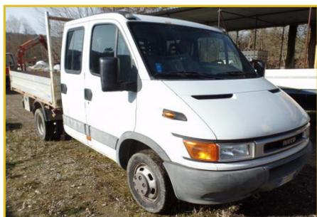
Autocarro Iveco 35C11 Daily cassone ribaltabile trilaterale, immatricolato il 14/09/2001, cilindrata 2800 alimentazione a gasolio, 78 Kw, portata 750.
