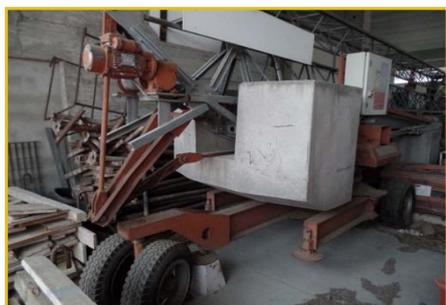
Lotto B)GRU edile a torre automontante marca Benazzato mod. 197 ? 14.16, braccio mt.16, altezza mt.14, portata max. Kg.1.000, portata max. in punta Kg. 400, con radiocomando, secchione e forca, anno di costruzione 2000.
