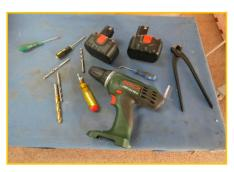
Trapano/avvitatore provvisto di 2 batterie ma privo di caricabatteria; tronchesi, 3 cacciaviti, 4 punte da trapano.
