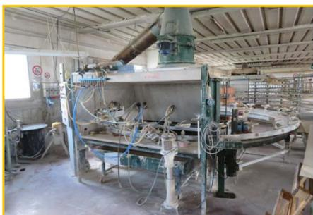
Lotto 2) Giostra per verniciature + pulitrice con vasca di immersione ed agitatore a motore + sminuzzatrice argilla + fustella a macchina per piastrella ad angolo 129 x 64,5.
