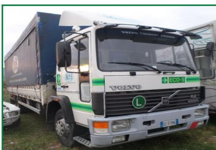
Autocarro VOLVO TRUCK targato BZ378NG, data immatricolazione 15/04/1994, cc. 5480 alimentazione a gasolio; telonato cassone a sponde provvisto di chiave blocchetto di accensione e mancante di chiave portiere. Il mezzo si accende e risulta marciante grazie ad un motorino di avviamento e blocchetto chiave non originale volvo, sprovvisto di librett...
