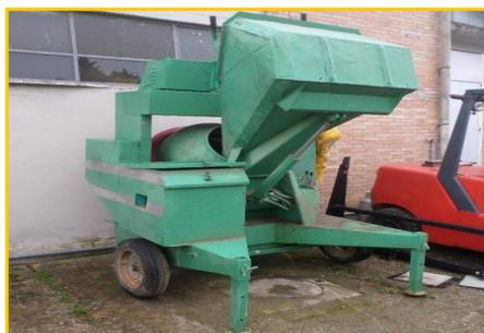
Betoniera ad inversione di marcia automontante.
