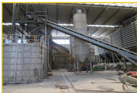
Impianto di betonaggio orizzontale per la produzione di calcestruzzo, comprensivo di 2 vasche a terra di pre-carico inerti, 12 tramogge di stoccaggio inerti, 5 silos per cemento, 2 mescolatori per impastaggio, 7 nastri per movimentazione materiale, 2 cisterne per additivi e bilance di pesatura comprensivo di vasca lavaggio betoniere, produttore ...
