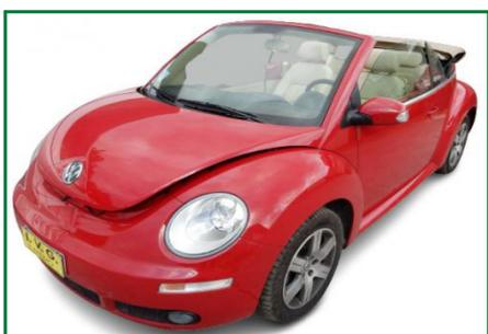
Autovettura Vw New Beetle Cabrio, data immatricolazione 04/01/2010, cc. 1896 alimentazione a gasolio, KW 77,00, Km da tachimetro 48.000, provvista di chiave e documenti, senza batteria. Allo stato attuale il veicolo risulta mancante di una candele, il mezzo gira a 3 cilindri, da ripristinare.
