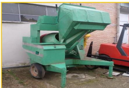
Betoniera ad inversione di marcia automontante.
