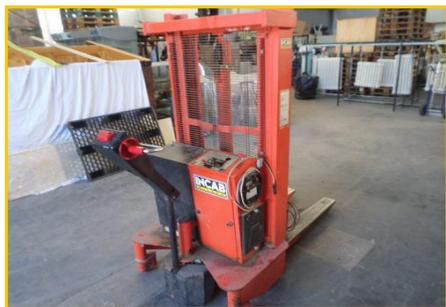
Transpallet elettrico Incab Milano provvisto di carica batteria.
