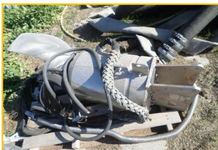
Agitatore in acciaio inossidabile marca FLIYGT elica potenza 13 KW numero di serie 4670-492-1260033.
