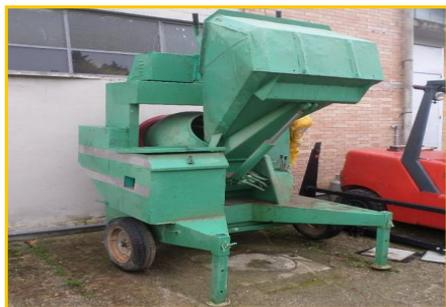
Betoniera ad inversione di marcia automontante.
