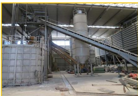
Impianto di betonaggio orizzontale per la produzione di calcestruzzo, comprensivo di 2 vasche a terra di pre-carico inerti, 12 tramogge di stoccaggio inerti, 5 silos per cemento, 2 mescolatori per impastaggio, 7 nastri per movimentazione materiale, 2 cisterne per additivi e bilance di pesatura comprensivo di vasca lavaggio betoniere, produttore ...
