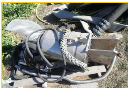
Agitatore in acciaio inossidabile marca FLIYGT elica potenza 13 KW
