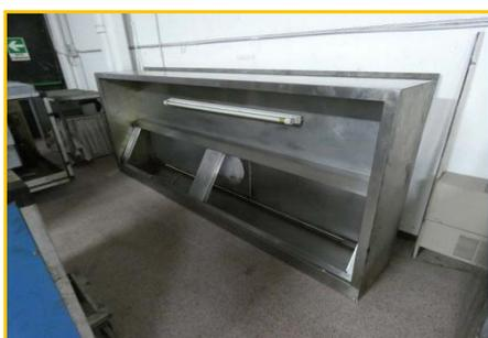
Cappa aspirante in acciaio inox completa di filtri misura 300 x 120.
